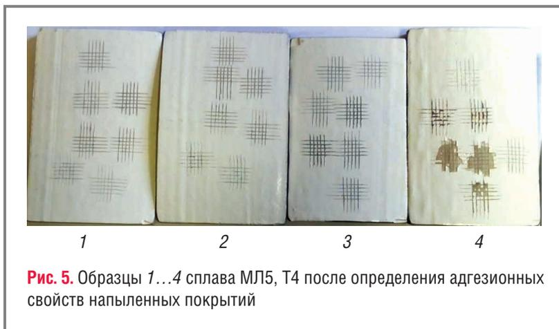
**Рис. 5.** Образцы 1...4 сплава МЛ5, Т4 после определения адгезионных свойств напыленных покрытий
