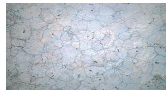
**Рис. 6.** Микроструктура матрицы отливки после напыления, сплав МЛ5, Т4
