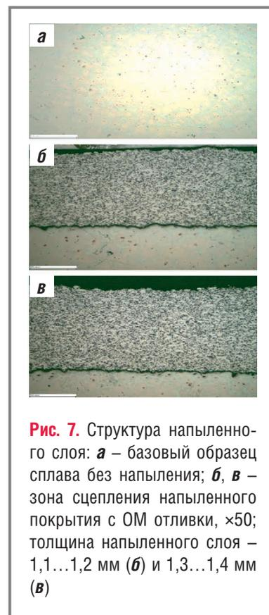
**Рис. 7.** Структура напыленного слоя: **а** – базовый образец сплава без напыления; **б, в** – зона сцепления напыленного покрытия с ОМ отливки,  $\times 50$ ; толщина напыленного слоя – 1,1...1,2 мм (**б**) и 1,3...1,4 мм (**в**)
